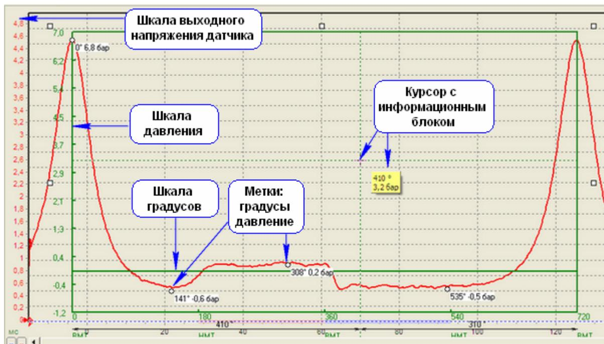
На такте выпуска топливовоздушной смеси, значение давления в цилиндре практически не превышает атмосферного. Повышение давления в цилиндре на такте выпуска может быть вызвано малым проходным сечением выпускных каналов отработавших газов, причиной чего может быть малый ход открытия выпускного клапана, "забит" катализатор, глушитель или выхлопная труба.
